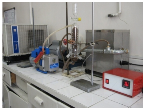
شکل ۱. نمای کلی دستگاه تقطیر مولکولی
