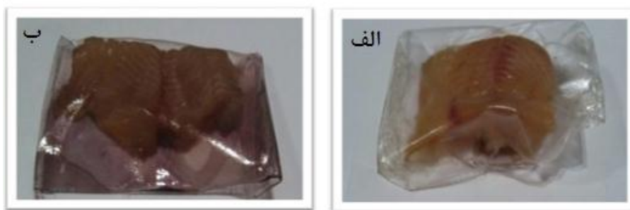
شکل ۲- تغییر رنگ فیلم‌های حاوی عصاره کلم در بسته‌بندی فیله‌های ماهی قزل‌آلا در ابتدا (الف) و انتهای دوره نگهداری (ب).
