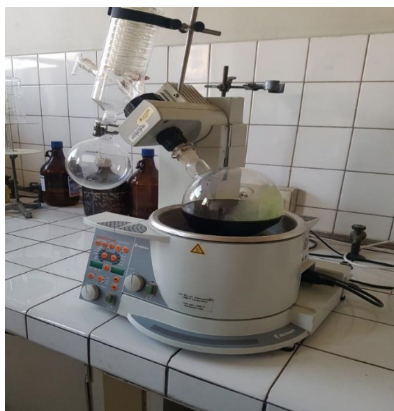
شکل ۳- تصویر جداسازی عصاره الکلی گیاه مامیران کبیر توسط دستگاه روتاری اوپراتور (تقطیر در خلاء).
