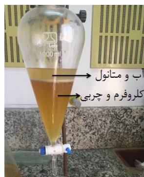
شکل ۲- جداسازی کلروفرم و چربی در روش بلایت و دایر از ماهی میکتوفیده
